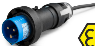
Abb. 33: Stecker bzw. Steckdose - 230 V; explosionsgeschützt (II 2G, Ex de, IIC, T6), 16 A, 3P (1P+N+PE) nach DIN
