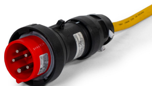
Abb. 34: Stecker bzw. Steckdose - 400 V; explosionsgeschützt (II 2G, Ex de, IIC, T6), 16 A, 5P (3P+N+PE) nach DIN
