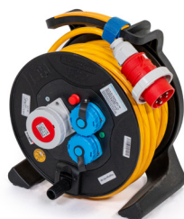
Abb. 32: Stecker bzw. Steckdose mit Schutzkontakt (6H) - 400 V, 16 A, 5P (3P+N+PE) nach DIN EN 60309-2 (VDE 0623-2) bzw. DIN EN 60529 (VDE 0470-1)
